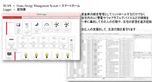
図3-6 データロガーの動作例
