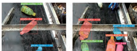
産学官連携! 画像認識AIによる飲料容器類自動分別装置の開発
